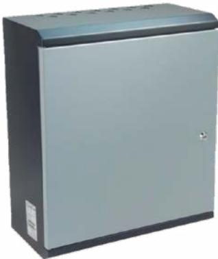
Las unidades de alimentación de la red, P-PSU, proporcionan un suministro de energía ininterrumpido para los dispositivos del sistema de alarma contra incendios de acuerdo con la norma EN 54-4 con 24 V CC y una corriente de hasta 5 A.
