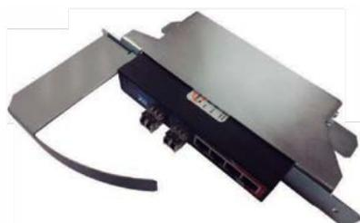
El POS800 es un conmutador que proporciona 4 puertos ethernet y 2 puertos de fibra óptica (SFP para la conexión de fibras monomodo) para conectar repetidores PROFILE adicionales. Esto permite a los usuarios conectar repetidores en configuración de bucle usando fibra óptica.
