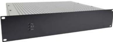
Cargador de batería para sistemas de evacuación por voz, conforme a la norma EN54-4. Diseñado para cargar baterías de plomo y al mismo tiempo, proveer de energía a aplicaciones auxiliares. Incluye 2 salidas de cargador con una potencia máxima de 960 W. Admite un NEO8060 con 2 baterías de 12 V y 45 Ah (baterías no incluidas).
