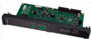
La tarjeta de monitorización PCH800 de PROFILE Flexible monitoriza el 95 % de la humedad relativa de las fuentes de alimentación auxiliares, la corriente de las baterías de emergencia y los cortocircuitos. También suministra la tensión de carga controlada dependiente de la temperatura para la fuente de alimentación de emergencia y transmite energía a la placa madre PFI.
