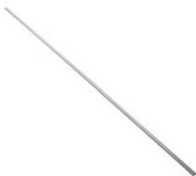
El carril de puesta a tierra ERL7 es un elemento niquelado de 3 x 10 mm (1 metro de longitud) de montaje muy sencillo. Puede alojar hasta 2,5 terminales de toma de tierra ETM7 por emplazamiento de barrera para conectar los retornos de tierra y los blindajes de los cables de la zona clasificada.
