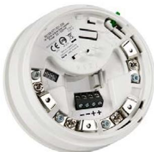
La base de relé de la serie 600 proporciona un relé de doble contacto para funciones de señalización destinadas a dispositivos externos en sistemas de detección convencionales. El uso de corrientes operativas de muy baja intensidad, incluso cuando se acciona el relé, permite utilizar esta base sin potencia auxiliar. Los contactos del relé se activan cuando el detector introduce la condición de alarma.
