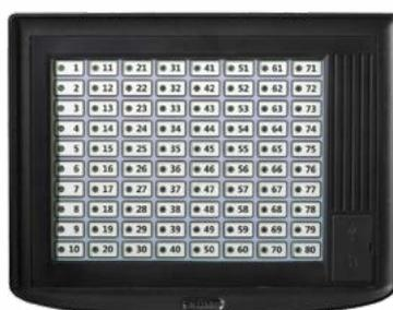
Módulo de aplicación para la puerta principal de la central de detección de incendios y alarmas PROFILE Flexible, una carcasa adicional o un repetidor. Contiene 80 LEDs de fallo programable para mostrar las alarmas, las alarmas de zona o los estados de E/S. Los LED pueden asignarse a cualquiera de los puntos del sistema.
