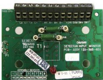
El DIM800 está diseñado para alimentar y monitorizar un circuito de detectores y pulsadores de alarma convencionales. El circuito de detección recibe la energía de una fuente de alimentación externa de 24 V CC que se controla a través de la central algorítmica MZX.
