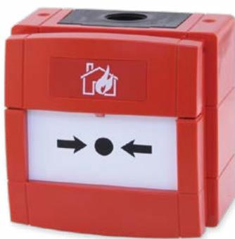
El MCP830 un pulsador de alarma analógico manual de uso exterior para centrales ZETTLER. Está equipado con un aislador integral y un LED de estado programable. En caso de que se produzca un cortocircuito en el bucle, el aislador desconecta la parte afectada del bucle de modo que las partes no afectadas sigan funcionando de forma normal. El pulsador MCP830 se comunica a gran velocidad con la central ZETTLER de alarma manual contra incendios. Certificado para la norma EN 54-11 y EN 54-17.
