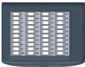
Módulo de aplicación para la puerta principal de la central de detección de incendios y alarmas PROFILE Flexible, una carcasa adicional o un repetidor. Contiene 40 LEDs de fallo programable (amarillo) y 40 LEDs de alarma (rojo) para mostrar las alarmas, las alarmas de zona o los estados de E/S. Los LED pueden asignarse a cualquiera de los puntos del sistema. Se pueden conectar hasta tres unidades PZ4x a una central.
