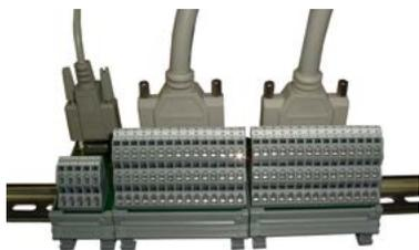
El conjunto de conexión de E/S ZETTLER SensorLaser Plus HD es necesario para conectar las 44 salidas de contacto aisladas y las 4 entradas integradas en la unidad de control. Las cajas de conexión incluidas en este conjunto están equipadas con terminales de conexión numerados en serie y pueden ser montadas en un carril en C estándar. Estas cajas se conectan a sus correspondientes enchufes SUB-D en la parte posterior de la unidad de control con estos cables de conexión.
