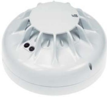
La gama se complementa con el detector de temperatura, que puede funcionar en modo termostático (temperatura fija) o termovelocimétrico (gradiente de temperatura), y con diferentes niveles de sensibilidad certificados. Se utiliza sobre todo en zonas con altos niveles de polvo o donde las condiciones ambientales impiden usar detectores de humo.
