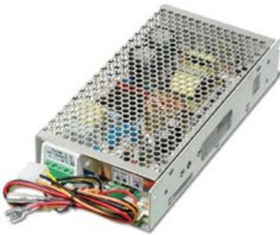
Unidad de alimentación de repuesto para todas las unidades centrales PROFILE Flexible y la fuente de alimentación auxiliar PBB801.
