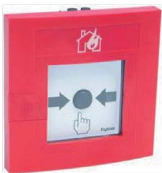
El pulsador de alarma DIN 820 es una alarma de accionamiento manual para áreas interiores que respeta las directivas definidas en DIN EN 54-11 y DIN EN 54-17. Tiene un LED de estado y un aislador de cortocircuito integrado. Con un puente, la alarma se puede poner en modo de mantenimiento.
