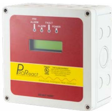
El detector de temperatura analógico ProReact está formado por un módulo de control y un cable de detección de cuatro núcleos diseñados para conectarse a una central de detección de incendios convencional o a un módulo analógico DIM800 o DDM800. El módulo de control supervisa la resistencia de los polímeros dopados del cable sensor, que cambia en función de la temperatura. Un cambio anómalo de la resistencia a lo largo del cable activa una prealarma o una alarma en el módulo de interfaz.
