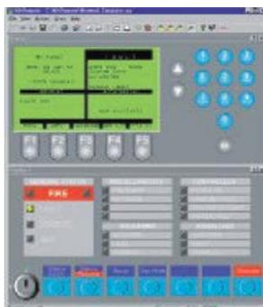
MXRemote es una herramienta Windows utilizada para prestar servicio y asistencia remota a las centrales de detección PROFILE y MZX. Proporciona un repetidor de la central totalmente funcional que se ejecuta en un PC de forma local o conectado a través de la línea telefónica o Internet.
