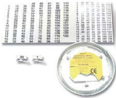
Los detectores de la serie 800 incluyen una función que transfiere automáticamente la marca de dirección a la base del detector cuando éste se conecta a la base. Cuando se retira el detector, la marca de dirección permanece en el techo para evitar que, al realizar operaciones de servicio o mantenimiento, los detectores se reinstalen en una base errónea.
