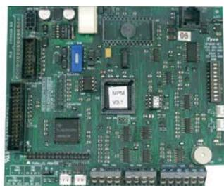
El módulo de interfaz multipropósito MPM800 puede utilizarse para interconectar varias tarjetas auxiliares con el bus remoto de la central PROFILE Flexible, por ejemplo las unidades de visualización de LEDs zonales o las tarjetas de E/S.
