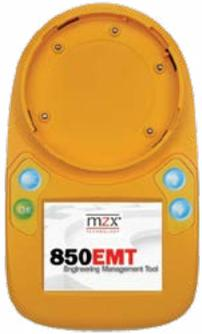
La herramienta de servicio se comunica con los dispositivos de las series 850 y 830 a través de un enlace inalámbrico infrarrojo bidireccional.
