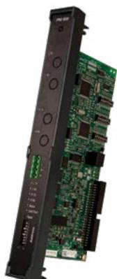
El nuevo diseño modular con tarjetas conectables hace que la ampliación sea más fácil que nunca. Se inserta en una ranura libre de la central. En la tarjeta hay 8 entradas para 4 bucles de potencia compartida (SP) u 8 líneas de derivación. Cada dos bucles de potencia compartida pueden conectarse para formar un bucle de alta potencia (HP) con una capacidad de 1 amperio y 250 direcciones.
