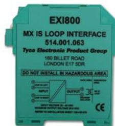
El módulo de interfaz EXI800 usado con un aislador galvánico, proporciona un camino para que una central MZX se comunique de forma transparente con los dispositivos esclavos (Detectores 800Ex). La interfaz EXI800 reduce la potencia normal del bucle MZX y las corrientes de señalización a niveles aceptables para zonas clasificadas. Además, puede detectar cortocircuitos en el bucle izquierdo, el bucle derecho o el ramal IS y aislar el circuito averiado de otras conexiones del bucle.
