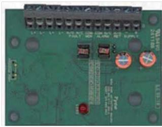
El módulo BDM800 está diseñado para actuar como interfaz entre los detectores lineales FIRERAY y el bucle analógico ZETTLER. Proporciona alimentación a través del bucle, supervisa las salidas de Incendio y Fallo del detector, y comprueba las conexiones para identificar fallos de circuito abierto y cortocircuito. Se entrega instalado en una carcasa doble estándar y simplifica enormemente el cableado normalmente asociado a la detección lineal.
