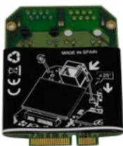
ONE500-LOOP es una tarjeta de expansión que permite conectar hasta 10 x ONE500 con un total de 60 zonas.
