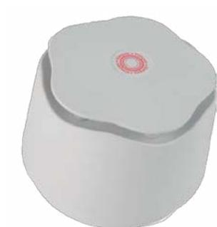
La sirena multitono BE-W IP45 es un transmisor de señal acústica de uso interior, que se suministra de manera convencional. Se puede elegir entre 32 tipos de sonido y tres ajustes de volumen, desde el máximo de 96-110 dB (dependiendo del tipo de sonido). El suministro incluye la base de montaje.
