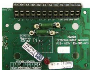
El DIM800 está diseñado para alimentar y monitorizar un circuito de detectores y pulsadores de alarma convencionales. El circuito de detección recibe la energía de una fuente de alimentación externa de 24 V CC que se controla a través de la central. El módulo monitoriza la corriente de 24 V CC externa y envía una señal de fallo si se interrumpe.
