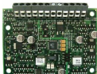
El DDM800 ofrece la posibilidad de conectar 2 zonas de detectores de incendios convencionales a 2 hilos o dos detectores de 4-20 mA y comunicarlos con las centrales de detección de incendios ZETTLER.
