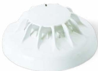
Este detector combina detección de CO y gradiente de temperatura de tal manera que la sensibilidad del sensor de CO aumenta cuando se detecta un cambio brusco de la temperatura.
