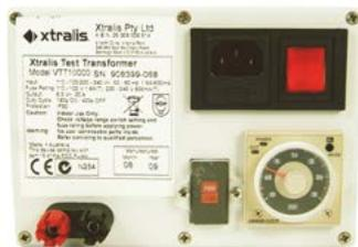
Caja de prueba de quemaduras de cable diseñada para calentar una longitud medida de cable especial para producir humo, utilizada para probar el tiempo de transporte y el rendimiento de los detectores de humo por aspiración Vesda.
