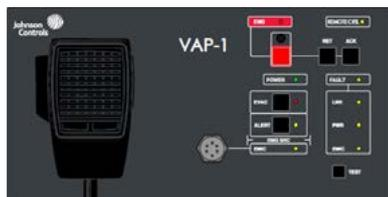
El panel de alarma por voz es un control remoto externo que incorpora un micrófono de emergencia y proporciona acceso directo a las funciones de evacuación por voz del sistema NEO. Permite al usuario dar múltiples avisos de evacuación con voz en directo y emitir mensajes de alerta y evacuación a un máximo de 56 memorias de selección de zonas PA en un sistema NEO.
