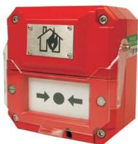
Pulsador de alarma manual rearmable de categoría Ex II 2 GD certificado para atmósferas con polvo y nivel de seguridad aumentada (EExemd). Se utiliza con el módulo de entrada resistente a la llama MIM800 EExd en una carcasa EExd dentro de un sistema analógico de detección y disparo para atmósferas explosivas con gas y polvo.
