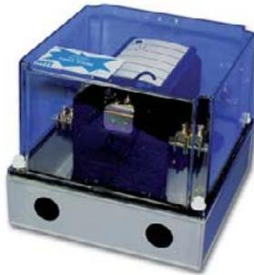
La serie de carcasas MT proporciona una forma fácil y eficaz de montar y proteger barreras de la serie MTL700 en zonas seguras o zonas clasificadas de bajo riesgo. Se compone de tres carcasas ligeras de policarbonato con tapa transparente y capacidad para alojar 2, 5 y 12 barreras en la zona segura. Todas las carcasas se entregan con una montura de barra colectora de latón niquelado, de manera que las barreras pueden instalarse y conectarse de inmediato y sin herramientas especiales.
