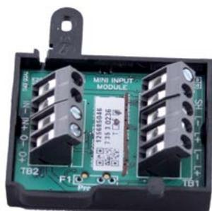
El MIM800 es un pequeño módulo analógico diseñado para monitorizar un solo circuito de entrada. Puede monitorizar entradas normalmente abiertas o normalmente cerradas y proporciona monitorización de circuito abierto y cortocircuito en la línea. Está diseñado para dispositivos pequeños, como los conmutadores de flujo, los dispositivos de detección especiales y los pulsadores de alarma a prueba de explosiones. En todos los pulsadores de alarma se utiliza una variante del MIM800.
