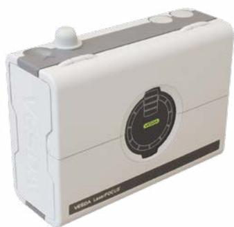
La tecnología de muestreo de aire de múltiples puntos del modelo VESDA LaserFOCUS funciona mediante un aspirador altamente eficaz que succiona continuamente el aire hacia la cámara de detección láser a través de una red de tubos. El resultado es un proceso de detección incomparable que puede proporcionar alertas tempranas, fiables y estables de detección de humo para una amplia variedad de aplicaciones.
