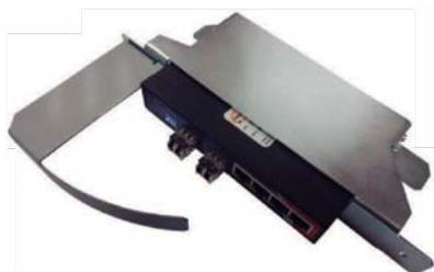
El POS800 es un conmutador que proporciona 4 puertos Ethernet y 2 puertos de fibra óptica (SFP para la conexión de fibras monomodo) para conectar repetidores PROFILE adicionales. Esto permite a los usuarios conectar repetidores en configuración de bucle usando fibra óptica.
