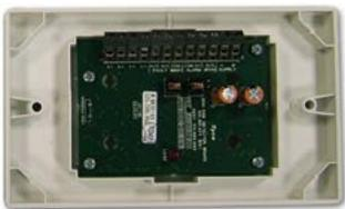
Para aquellas ocasiones en que es necesario situar el módulo BDM800 a cierta distancia del detector lineal, disponemos de un módulo de terminación opcional (BTM800) que reduce y simplifica el cableado. Este módulo viene instalado en una cubierta doble estándar y posee todas las conexiones y elementos necesarios para minimizar el tiempo de instalación.
