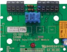
Este módulo proporciona una entrada supervisada y una salida de contacto seco. Consta de una entrada para comprobar el estado de un contacto normalmente abierto y un relé de contacto conmutado. El relé se controla mediante un comando enviado desde la central contra incendios a través del bucle analógico.
