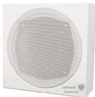
Altavoz de superficie de Johnson Controls con certificado EN 54-24 y carcasa metálica de 5" para líneas de 70/100 V, idóneo tanto para música como para aplicaciones de voz de alta calidad. Está diseñado para su instalación en superficie, tanto en techos como en paredes.
