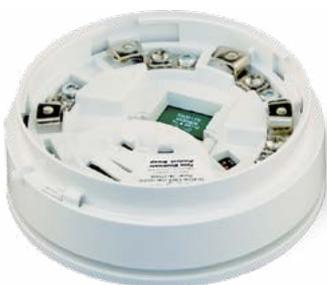
El 801RB es un auxiliar MX que está diseñado para ser manejado desde el bucle analógico MX. La base de relé 801RB provee dos contactos de relé sin tensión capaces de conmutar 1 A a 30 V CC. El relé funciona bajo el control del controlador MX. La base de relé 801RB requiere un detector asociado para funcionar, ya que utiliza la dirección del detector que está instalado en ella.
