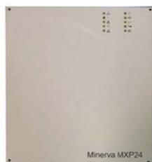
Esta fuente de alimentación está certificada por IMQ según las normas EN 54-4:1997 + A1:2002 y EN60950-1:2001. La caja de acero contiene una fuente de alimentación conmutada de 5 A y una tarjeta de monitorización, y tiene espacio para alojar 2 baterías de plomo-ácido selladas de 12 V y 17 Ah. Los 10 LED del panel frontal indican el estado de la unidad.
