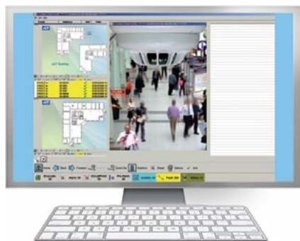
La función de vídeo IP permite ver imágenes en tiempo real de la zona en peligro cuando se produce una alarma o un fallo. Las imágenes de vídeo del área afectada aparecen automáticamente en la pantalla, lo que permite evaluar rápidamente la gravedad de la situación y emprender las acciones oportunas.
