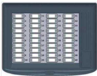
La PZ4DS es una unidad indicadora de LEDs de zona para sistemas PROFILE. Para cada zona se puede mostrar una alarma o fallo mediante un LED rojo/amarillo. Los LED pueden asignarse a cualquiera de las zonas de la central. Se pueden conectar hasta 3 PZ4DS a una central de detección de incendios y de alarma.
