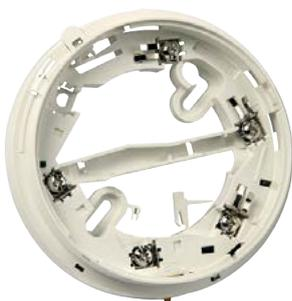
Base estándar de 4 pulgadas con diodo de continuidad compatible con todos los detectores de la Serie 600. La base está diseñada para asegurar que los sistemas convencionales cumplan los requisitos de la norma BS5839 Pt:1 para los pulsadores de alarma colocados después de los detectores.
