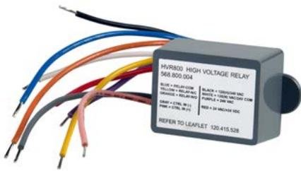
El HVR800 es un dispositivo no direccionable que utiliza un relé de baja corriente para conmutar corrientes de hasta 10 A. Como alternativa, es posible utilizar una señal de control de baja tensión como la suministrada por el RIM800 o el módulo Mimic de 80 zonas para conmutar el relé de corriente a través de la entrada optoaislada.
