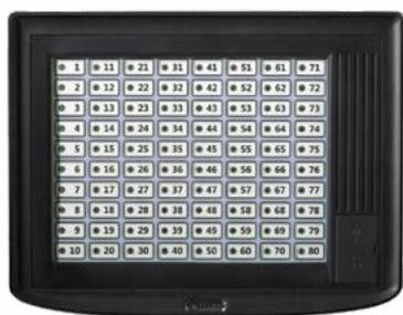
La PZ8DS es una unidad indicadora de LEDs de zona para sistemas PROFILE. En cada zona se puede mostrar una alarma mediante un LED rojo. La PZ8DS contiene 80 LEDs que pueden asignarse a cualquiera de las zonas de la central. Se pueden conectar hasta 3 PZ8DS a una central de detección de incendios y de alarma para poder mostrar el estado de las 240 zonas de software de la central.
