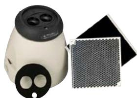
Cabezal detector adicional para la unidad de control del FIRERAY 5000. Una unidad de control puede reequiparse con 2 cabezales detectores, teniendo en cuenta que todos los aparatos deben ser utilizados dentro de la misma zona de detección de incendios.
